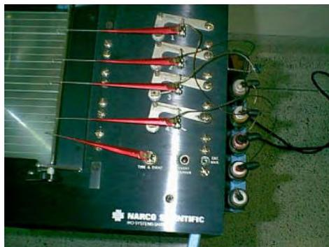
Figura 2.2. Aspecto de los galvanómetros de registro de un Fisiógrafo con las plumillas insertadas.
