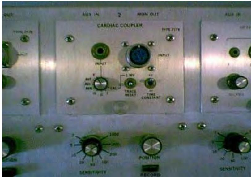
Figura 2.3. Acoplador para ECG.
