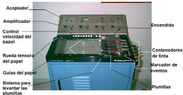
Figura 2.1. Fisiógrafo típico. Se indican las partes principales.
